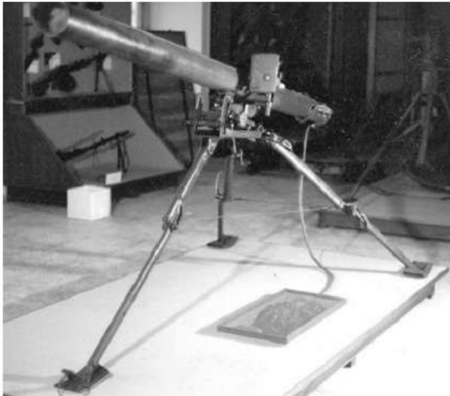
O LANÇADOR UNI-TUBO 9M28/DKZ-B, para os FOGUETÕES 9P132/BM-21-P, de calibre 122mm era este o míssil mais utilizado nos ataques por foguetões
